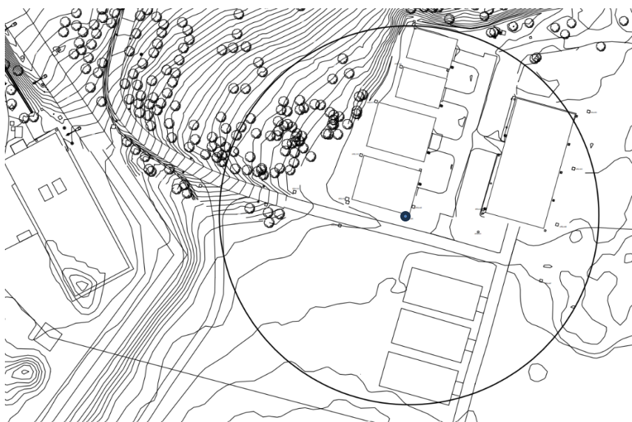
Figura 41: Situación en almacén C3 y alcance de pararrayos a instalar.
