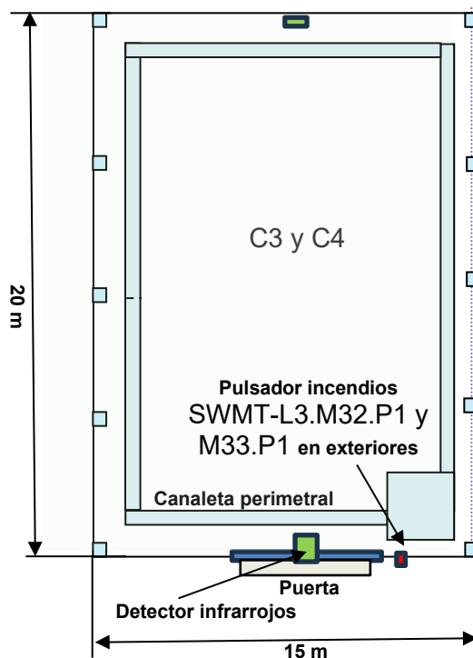
Figura 46: Disposición detectores infrarrojos en C3 y C4.
